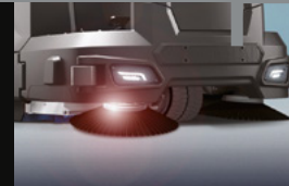
2 seitliche Kehrbürsten, die die Reinigungsleistung entlang der Wände erhöhen (für die Cylindrical Ausführungen erhältlich)
